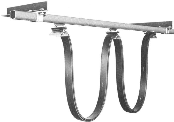
Leitungswagen für Spezial-Laufschiene werden für 2 Laufschiene-Größen hergestellt und sind infolge ihrer kleinen Bauweise für Anlagen mit beengten Raumverhältnissen besonders geeignet.
